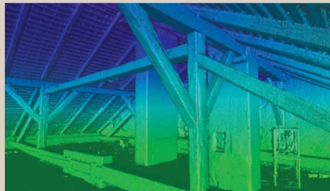
2.10 Homogénne rozloženie reziduí medzi mračnom z TLS a zo softvéru PhotoScan – Hausdorffova vzdialenosť (veľkosť reziduí) je počítaná ako najkratšia vzdialenosť bodu jedného mračna od bodov druhého mračna.
