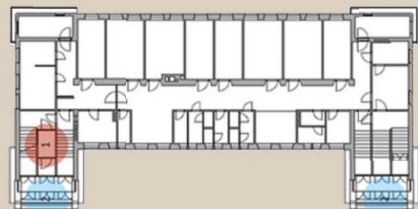
4.11 Pôdorys prízemnia s označením výfahu umiestneným v schodiskovom zrkadle (postavený v 60. rokoch 20. storočia).
