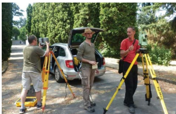
2.1 Laserový skener Trimble TX5 (vľavo) a UMS Leica TCR 407 (vpravo) v lokalite „starej“ nemocnice.
